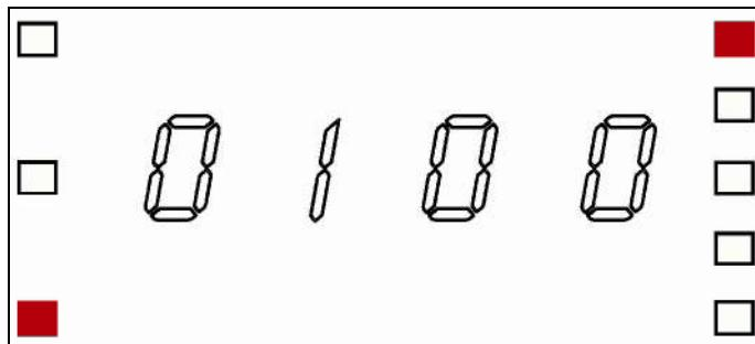
با چرخاندن ولوم، زمان از 100 ms تا 3000 ms قابل تنظیم است . در این حالت نشانگر دستگاه به حالت چشمک زن در می آید. سپس با فشار دادن ولوم به داخل مقدار تنظیم شده ذخیره و نشانگر ثابت می ماند .
