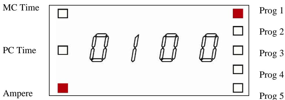
با چرخاندن ولوم هرزگرد ، جریان از 100 تا 2000 A قابل تنظیم است. در این حالت نشانگر دستگاه به حالت چشمک زن در می آید سپس با فشار دادن ولوم به داخل مقدار تنظیم شده ذخیره و نشانگر ثابت می ماند .
