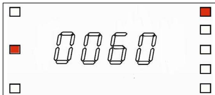
با چرخاندن ولوم، زمان از 10 ms تا 3000 ms قابل تنظیم است. در این حالت نشانگر دستگاه به حالت چشمک زن در می آید سپس با فشار دادن ولوم به داخل مقدار تنظیم شده ذخیره و نشانگر ثابت می ماند .
