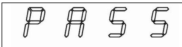
در حالت استاندارد پسورد یا کلمه عبور دستگاه **1234** می باشد با وارد کردن این عدد و ورود به قسمت (Set.p) سمت پسورد می توان کلمه عبور جدید را تعریف کرد.
