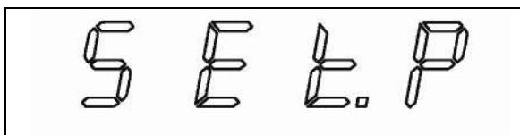
دقت : در هر مرحله از وارد کردن رمز در صورتی که 3 بار رمز، اشتباه وارد شود دستگاه باید خاموش و روشن شود و مراحل مجدداً تکرار شود.
