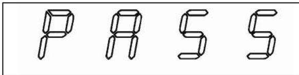
در حالت استاندارد پسورد یا کلمه عبور دستگاه **1234** می باشد با وارد کردن این عدد و ورود به قسمت (Set.p) ست پسورد می توان کلمه عبور جدید را تعریف کرد.
